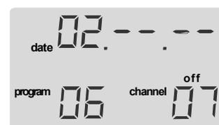
Les garde-place facilitent surtout l'écriture des programmes cycliques. On peut les insérer dans la ligne de date à la place de chaque couple de chiffres, v. aussi l'exemple p. 16.
